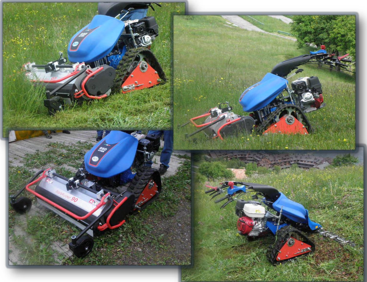
**BCS 660 HYVS con trincia e barra falciante**
